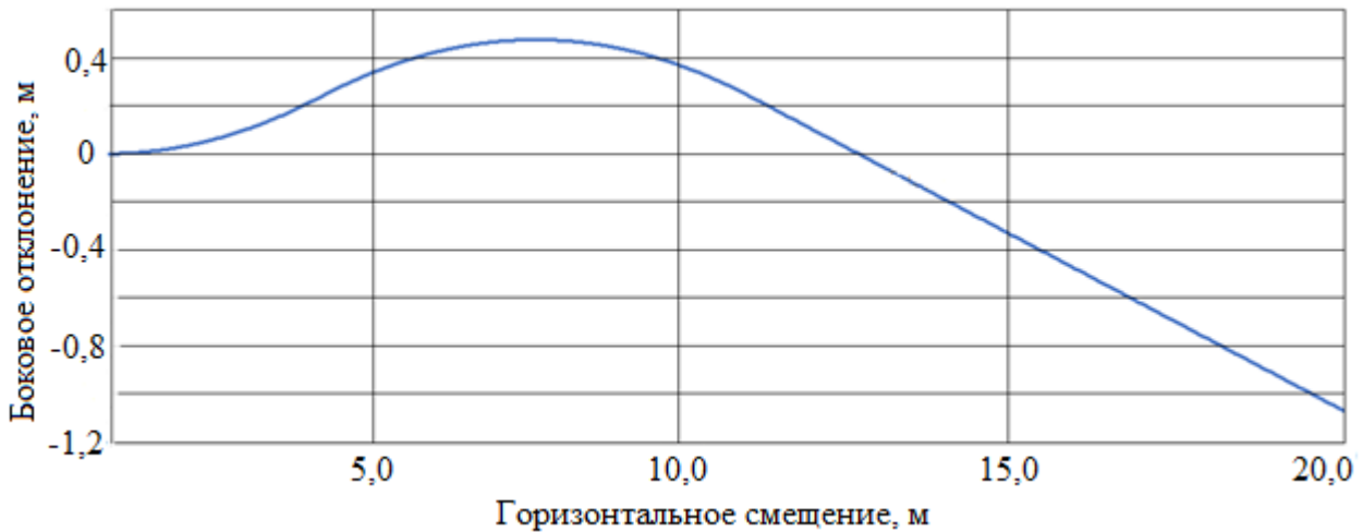
Рисунок 2 – Теоретическая траектория движения абсолютно управляемого объекта при управляющем воздействии, задаваемом требованиями глобальных технических Правил ООН № 8
