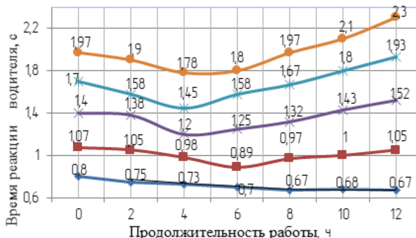
Рисунок 2 – Зависимость времени реакции от продолжительности работы
