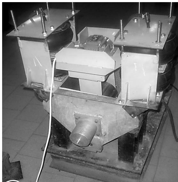
Рисунок 3 – Экспериментальный образец виброупрочняющего устройства с двухмассовой системой
