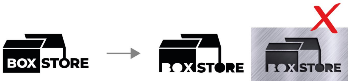
Рисунок 1 – Неудачная адаптация логотипа к сквозной резке на твердой поверхности
