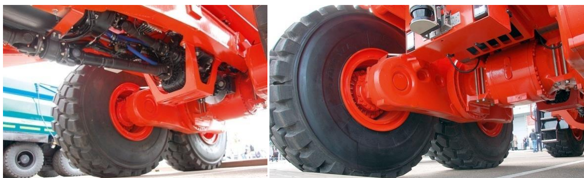
Рисунок 7 – Тандемный мост полноприводного самосвала
