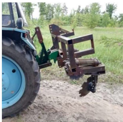
Рисунок 1. Лабораторный образец комбинированной почвообрабатывающей машины с дисковыми орудиями в полевых условиях
