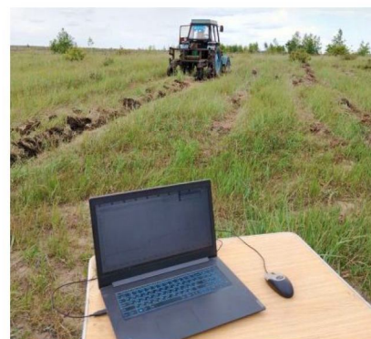
Рисунок 2. Общий вид тензометрического оборудования: а – тензометрическое оборудование; б – тензометрическое оборудование с тензонавеской в работе
