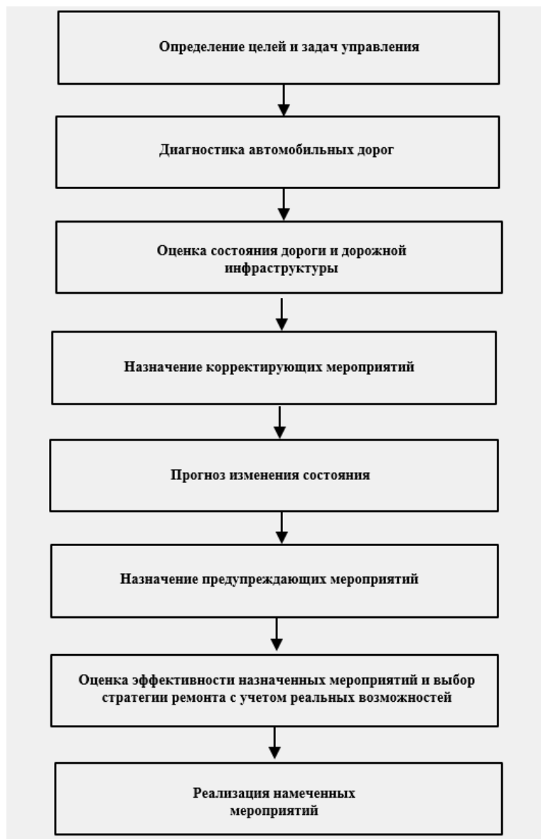
Рисунок 4 – Этапы системы управления состоянием автомобильных дорог
