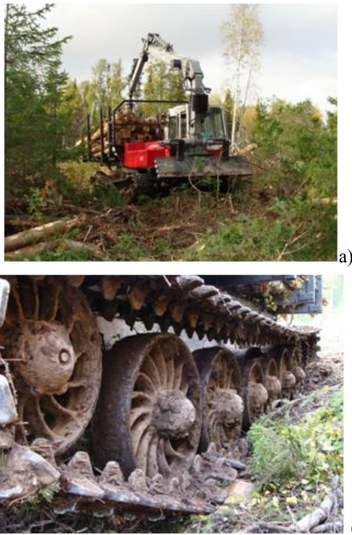
Рис. 1. Экспериментальные исследования (испытания) по преодолению единичных неровностей а) ГЛЗМ ЛЗ-5 на лесосеке; б) наезд на единичное препятствие
