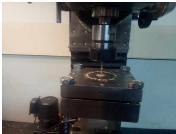
Рисунок 1 – Собранная установка для определения осевой силы при сверлении деталей из дюралюминия Д16 в напряженном упругодеформированном состоянии
