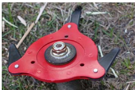
Рис. 3. Общий вид ротора с шарнирно установленными лезвиями Figure 3. The general view of the rotor with the rotating blades
