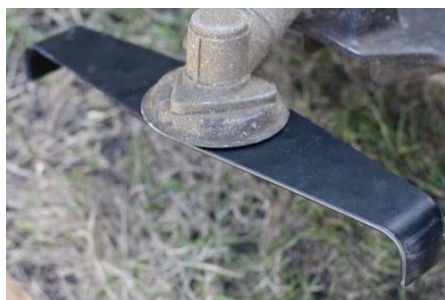
Рис. 1. Общий вид ротора с жестко установленным лезвием Figure 1. General view of the rotor with a rigidly installed blade
