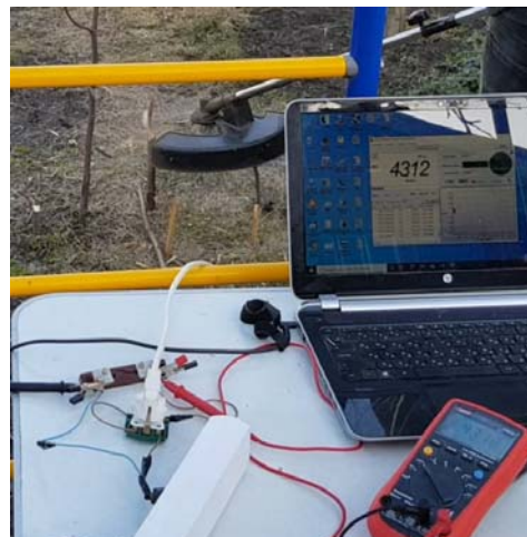
Рис. 7. Измерение напряжение при резании ветвей
