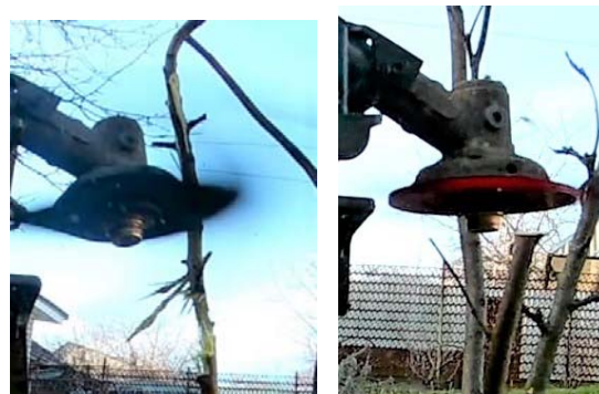
Рис. 8. Резание ветвей: а – жесткое лезвие, б – шарнирно-сочленённый нож
