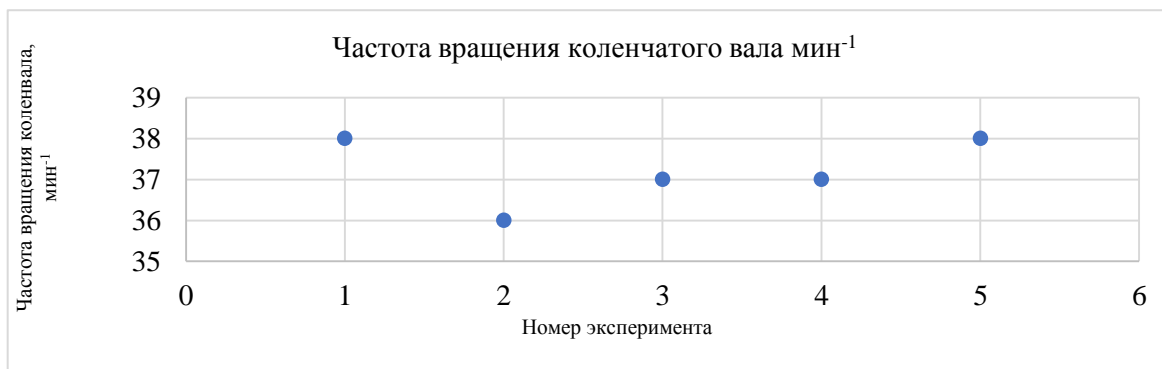
Рисунок 7 – Снижение частоты вращения коленчатого вала двигателя, \text{мин}^{-1} , при поочередном отключении 5-и цилиндров после бестормозной обкатки
