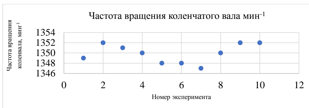
Рисунок 4 – Частота вращения коленчатого вала двигателя, мин -1 , при отключении группы цилиндров № 5-7-8-6-13-15-16-14 после бестормозной обкатки
