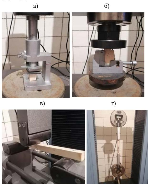
Рисунок 1. Испытание образцов термически поврежденной древесины: а) на сжатие вдоль волокон, б) на скалывание вдоль волокон, в) на поперечный изгиб, г) на растяжение
