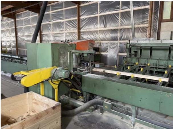
Рисунок 6. Автоматический торцовочный станок
