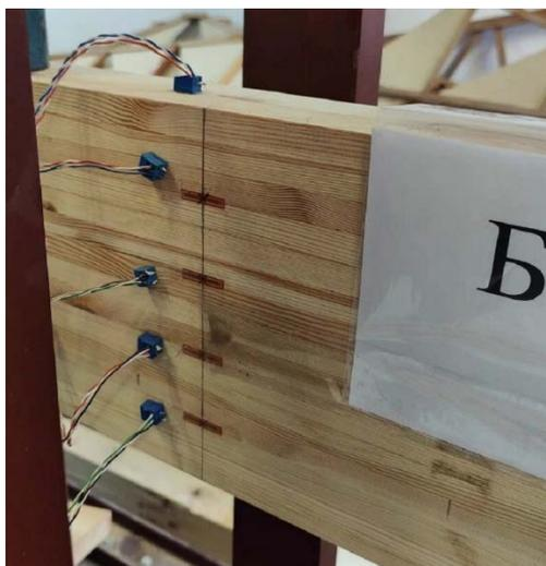
Рисунок 14. Размещение тензорезисторов: а) на опоре балки; б) в пролете
