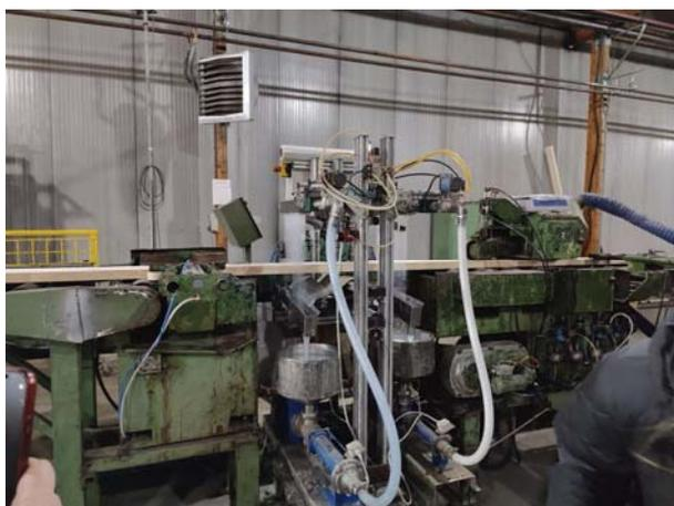
Рисунок 8. Участок автоматизированного нанесения клея и отвердителя
