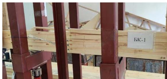
Рисунок 15. Разрушение балки БК-1 в зоне растяжения
