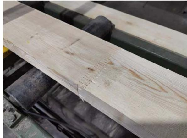
Рисунок 7. Шиповое соединение ламелей
