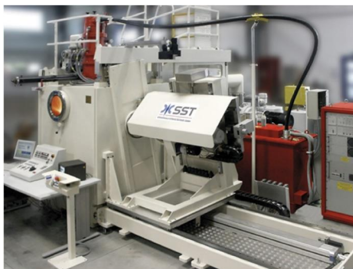
Рисунок 2 – Установка фирмы Steigerwald с многокоординатным ЧПУ для перфорирования плоских металлических заготовок электронным лучом
