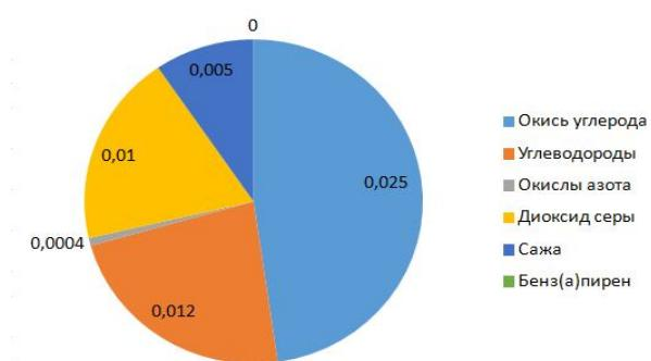
Рис. 3. Удельные выбросы при сгорании дизельного топлива, т/т
