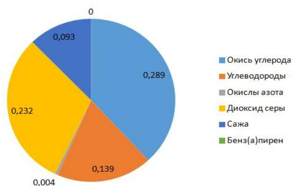
Рис. 4. Выброс от сжигания дизельного топлива, г/с
