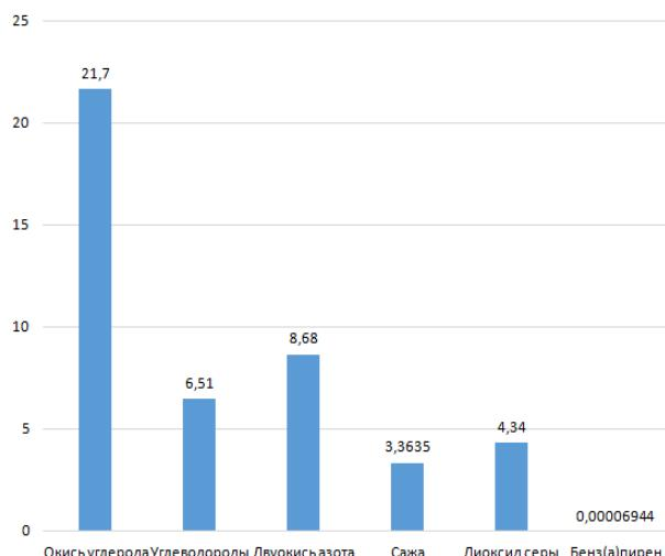
Рис. 1. Количество загрязняющих веществ, т/год при расходе дизельного топлива 217 т
