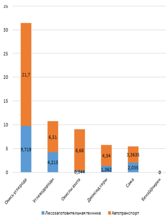
Рис. 5. Выбросов загрязняющих веществ от лесозаготовительной техники и автотранспорта при заготовке леса, т/год
