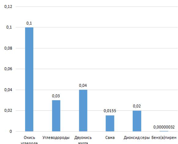
Рис. 2. Удельные выбросы загрязняющих веществ дизельными двигателями автотранспорта, т/т при расходе дизельного топлива 217 т
