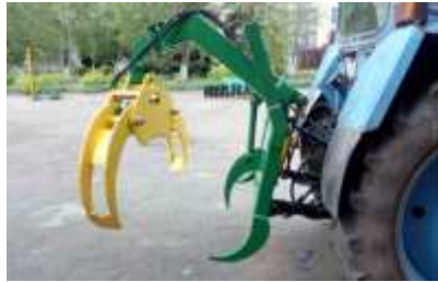
Рисунок 5 / Figure 5. Устройство трелёвочное универсальное УТУ-2 «ПАУК-М» / Universal skidding device UTU-2 «ПАУК-М»
