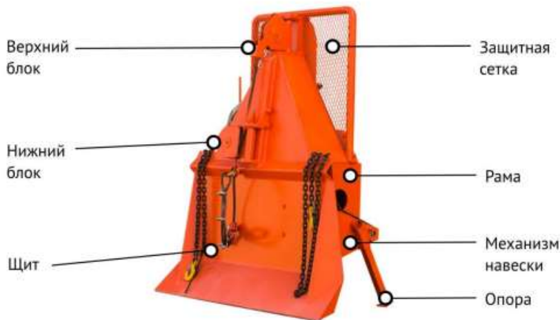
Рисунок 3 / Трелёвочная лебёдка ЛТН-50 / Figure 3. Skidding winch LTN-50
