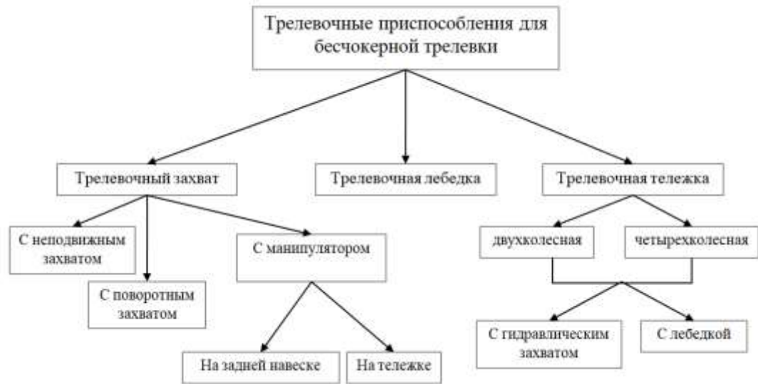
Рисунок 4 / Figure 4. Виды трелёвочных приспособлений для бесчokerной трелёвки / Types of skidding attachments for chokerless skidding
