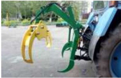
Рисунок 5 / Figure 5. Устройство трелёвочное универсальное УТУ-2 «ПАУК-М» / Universal skidding device UTU-2 "PAUK-M"
