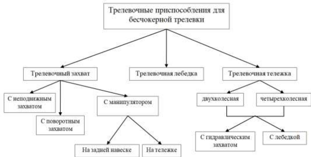
Рисунок 4 / Figure 4. Виды трелёвочных приспособлений для бесчокерной трелёвки / Types of skidding attachments for chokerless skidding Источник: собственная схема авторов / Source: authors' own scheme
