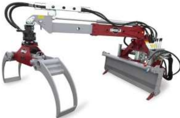
Рисунок 8 / Figure 8. Трелёвочный грейферный захват HRZ Lader / HRZ Lader skidding grapple
