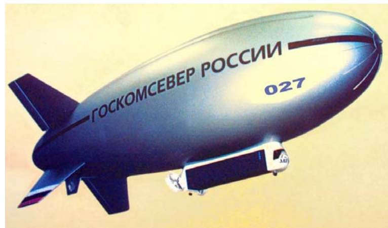
Рис. 2. Транспортно-грузовой дирижабль МД-900
